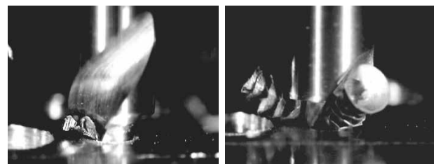
Fig.8 実験による切りくず排出状況の違い
